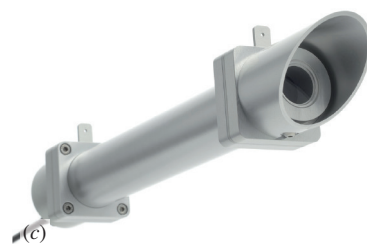
FIGURA 6.1.1 Misuratori della radiazione: (a) Solarimetro a termopila di Kipp; (b) Piranometro a effetto fotovoltaico; (c) Pireliometro (fonte: Wikimedia, Hukseflux Thermal Sensors – licenza CC BY 4.0).
